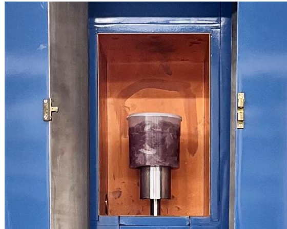
Mit dem Gammaskontrometer wird der Cäsium-137-Gehalt im Wildschweinfleisch bestimmt.
